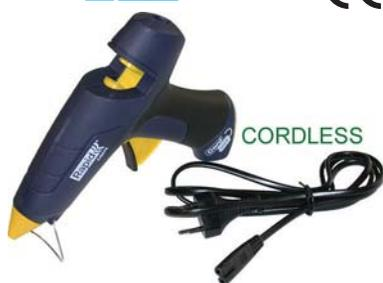
Tipo semi professionale, con avanzamento a grilletto, versatile e pratico. Grazie al cavo staccabile, si può lavorare collegati alla rete elettrica oppure senza collegamento per incollature in posizioni di difficile accesso e senza prese elettriche nelle vicinanze. Raggiunta la temperatura di lavoro, si hanno 7 minuti circa di autonomia.
